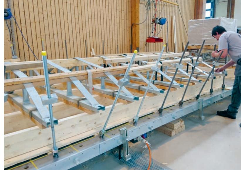
Um die Deckenelemente möglichst schlank zu halten, wurden sie als Rippendecken verklebt und mit der pneumatischen Pressvorrichtung der Woodtec Fankhauser GmbH mit bis zu vier Tonnen pro Presseinheit verpresst.
